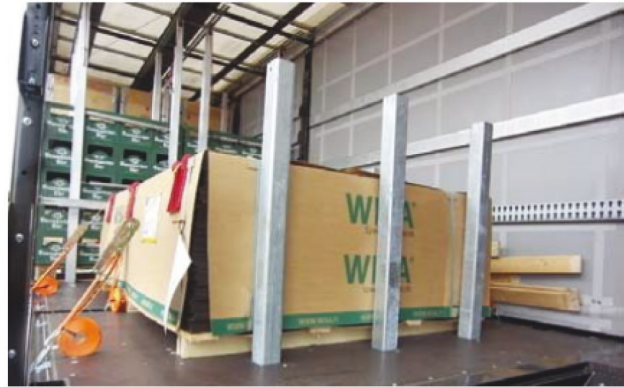
Figur 7: Kæpstokke anvendt til blokering i fremadgående retning
