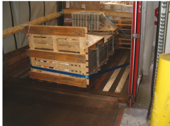
Figur 75: Anordning til fastgørelse bagud til blandet last
