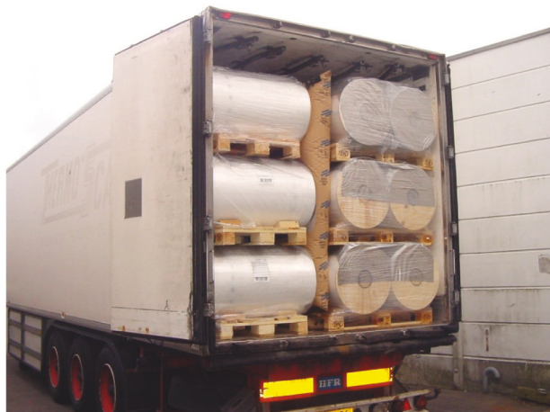
Figur 28 Fyldmateriale mellem rækker af last
