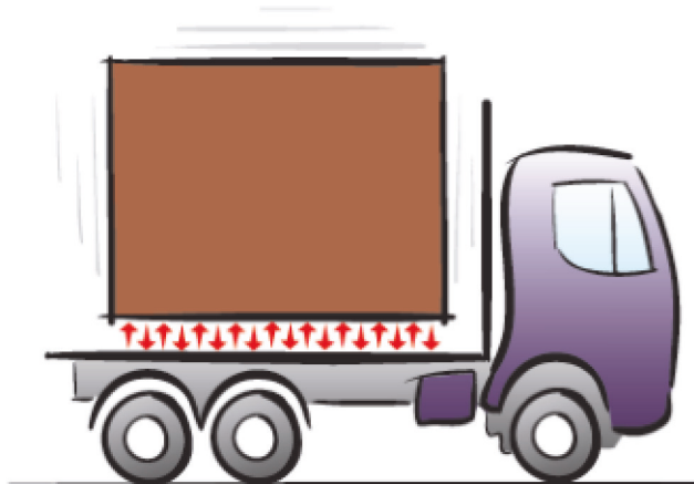
Figur 3: Vertikal vibration under kørsel
