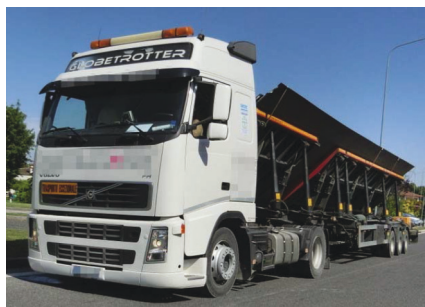
Figur 14: Stålplader transporteret under 45°
