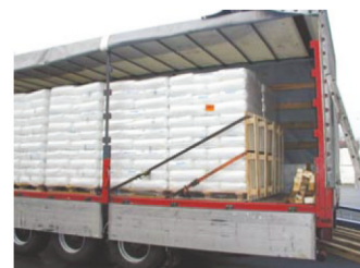
Figur 39: Fjederbelastet surring med paller
