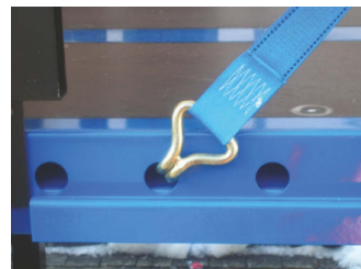
Figur 13: Ankerhuller i sideprofil
